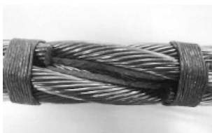
図 4. 6 オメガフィラー®ロープの一部 ストランドを取り外した外観
