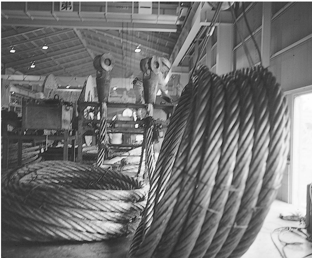
120mmロープのワイヤソケット加工
