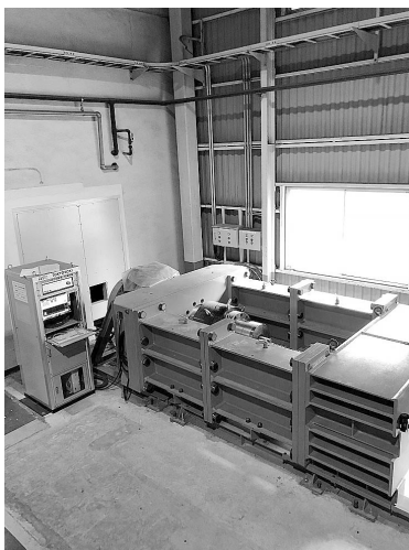
2000kN引張疲労試験機
