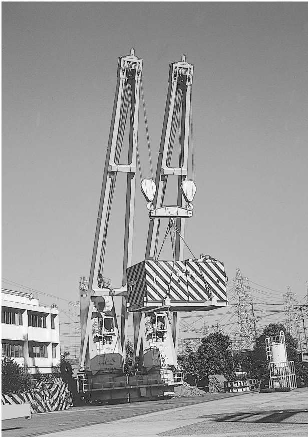
世界最大の60t×2 デッキクレーンに用いられた ユニロープF39形47.5mm
